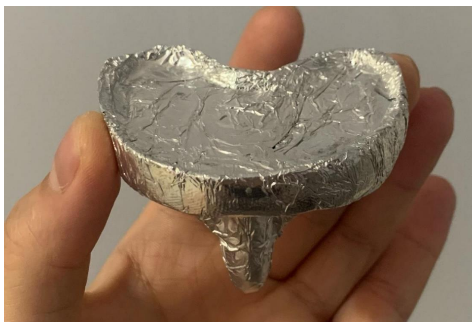
Рисунок 40 – Физическая модель прототипа, металлический элемент большеберцовой кости, аксонометрический вид
