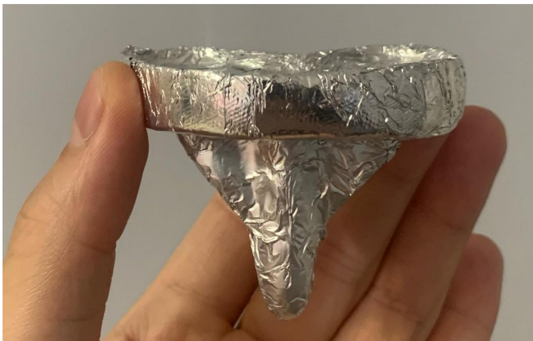
Рисунок 39 – Физическая модель прототипа, металлический элемент большеберцовой кости, фронтальный вид
